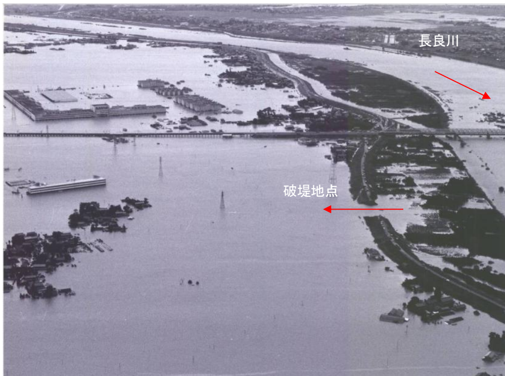
長良川 安八町大森 長良川右岸の破堤状況 図- 1.2 昭和 51 年 9 月洪水浸水状況写真
