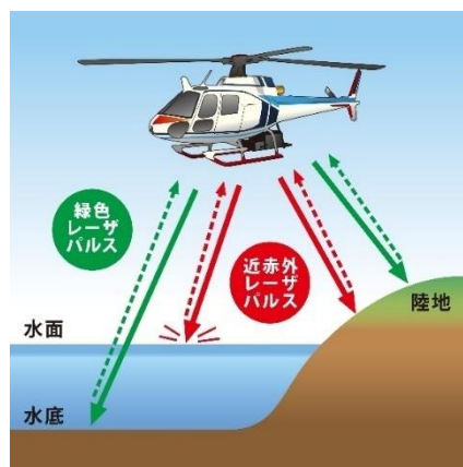
図- 2.8 航空レーザ測深（ALB）の計測イメージ河道の三次元計測データ
