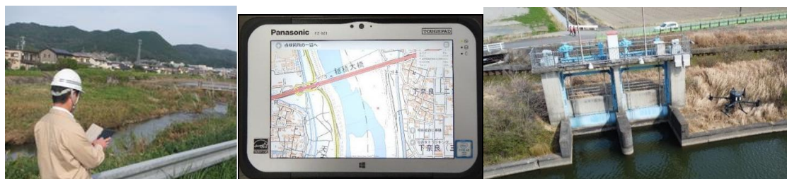
図- 2. 7 GPS 機能付きタブレット点検、ドローン（無人航空機）の活用
