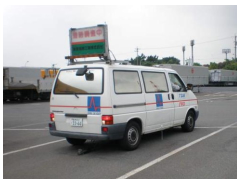
写真 4-3 FWD 調査状況
