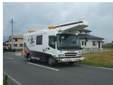
写真 2-3 舗装の点検状況
