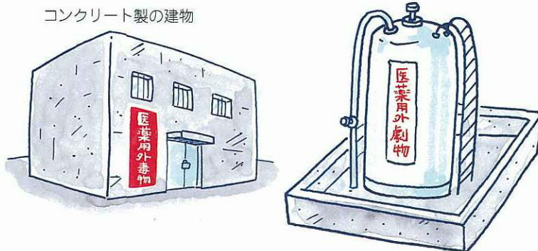
基礎も濡れたり染みだしたりしないコンクリートにする。
