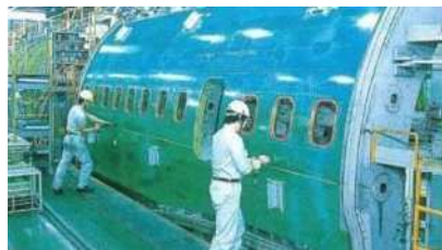
民間航空機の主な製造工程(胴体パネルの結合)
