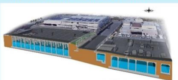
例: 大和川水系大和川 奈良県田原本町 社会福祉協議会駐車場他地下貯留施設整備
