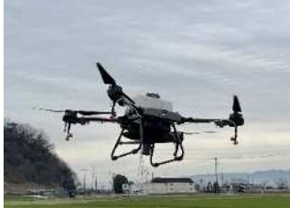
農業用ドローンは、4つのプロペラで飛行する四軸飛行機です。機体下部に農薬や肥料のタンクが搭載されており、空中から散布することができます。                                                  | <ul style="list-style-type: none"> <li>タンクを搭載し、農薬、肥料等を空中から散布することができる。</li> <li>農薬、肥料の散布作業時間を削減できる。</li> </ul>                                                 |
