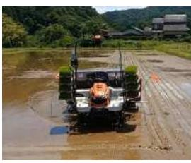
ロボット田植機は、田んぼで自動で田植作業を行う機械です。監視者が圃場周辺にいる状態で、旋回も含めて自動で田植作業を行うことが可能。                                                    | <ul style="list-style-type: none"> <li>監視者が圃場周辺にいる状態で、旋回も含めて自動で田植作業を行うことが可能。</li> </ul> <p>※ロボット田植機の操作は、メーカーの研修受講が必要であるため、直進アシスト機能を体験予定。</p>                  |
