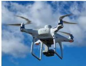
センシングドローンは、4つのプロペラで飛行する四軸飛行機です。機体下部にセンサーが搭載されており、可視光だけでなく、紫外線や赤外線など人間の目では見えない波長の光をとらえることができるカメラを搭載し、上空から撮影を行うことができる。 | <ul style="list-style-type: none"> <li>可視光だけでなく、紫外線や赤外線など人間の目では見えない波長の光をとらえることができるカメラを搭載し、上空から撮影を行うことができる。</li> <li>撮影したデータを解析することで、作物の生育状況を把握できる。</li> </ul> |
