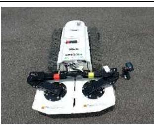
リモコン草刈機は、リモコンで操作する小型の草刈機です。全高400mmで人が入りにくい低くて狭い場所でも草刈作業が可能。                                                          | <ul style="list-style-type: none"> <li>リモコンで操作ができ、全高400mmで人が入りにくい低くて狭い場所でも草刈作業が可能。</li> <li>アタッチメントによって様々な作業ができる。</li> </ul>                                  |
