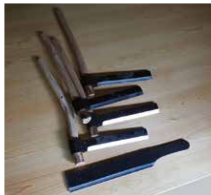
助成金で製作した樽へぎの道具
