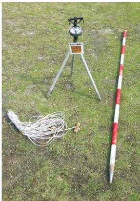
こちらは林業用の測量セット。左から検縄、ポケットコンパス、ポールの3点セットです。この3つを使って方位角・斜距離・高低角を測ることで、急峻な山の斜面でも面積を求めることができる、昔ながらの磁力を利用した測量器具です。測点を決めて、ポケットコンパスからポール (測点) の方位角・斜距離・高低角をポケットコンパスと検縄を使って測定します。
