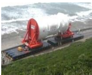
原子炉圧力容器の 陸上輸送の様子
