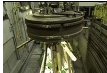
②マグネットで吊り 上げ溶解炉へ
