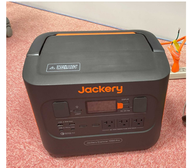
スターリンク回線維持のための非常用バッテリー電源 (電力は所内の非常用発電システムからの給電を可能にする)
