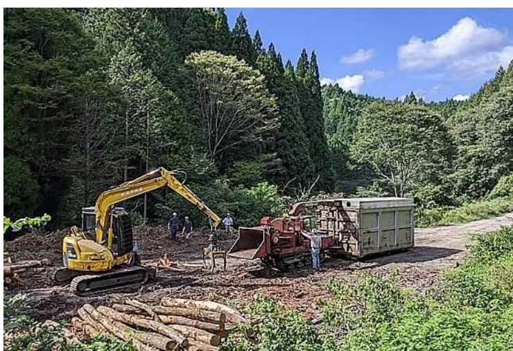
写真-2 現地（山元）でのチップ化（岡山県真庭市）
