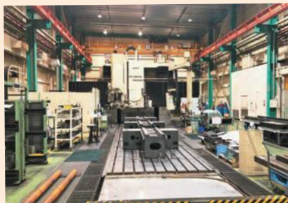
▲大型の門型研削盤／通年温度管理している
