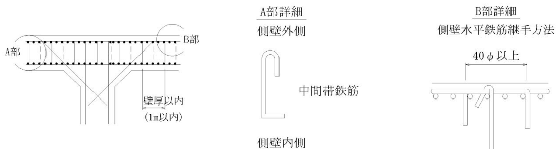
図 3.6.2 側壁水平断面の配筋
