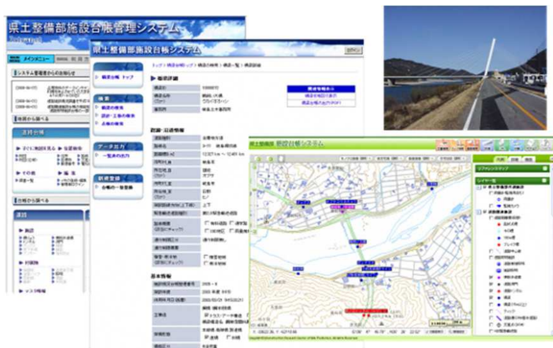
図 3-4 県域統合型GIS上で動作する道路施設の台帳管理システム
