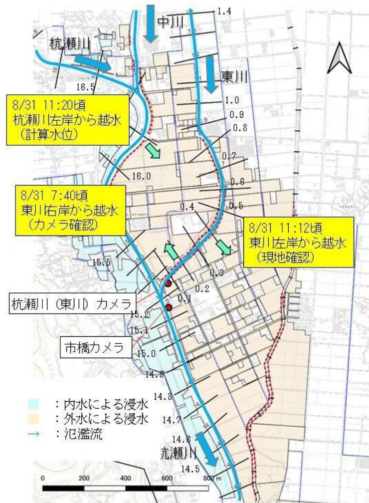
図4-1 杭瀬川・東川の氾濫
