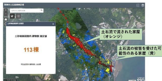
土石流被害区域の被害家屋把握支援 （ドローン画像と家屋地図等の重ね合わせ）
