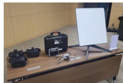
〔VRゴーグル・情報収集用ドローン・可搬型衛星通信機器(Starlink)〕
