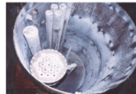
大洗での炭酸塩化処理後の機器内部のナトリウム炭酸塩の付着の様子
