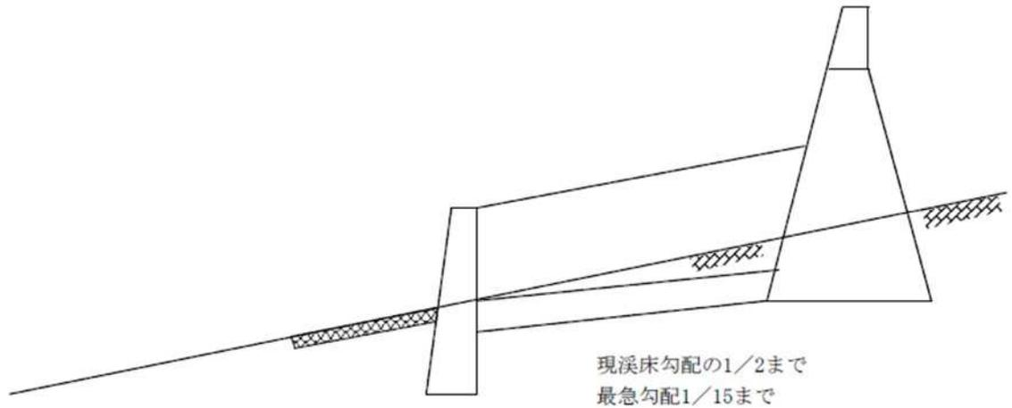
やむを得ず垂直壁の水通し天端と下流溪床との落差が生じた場合は、さらに、第2水叩工を設けること。
