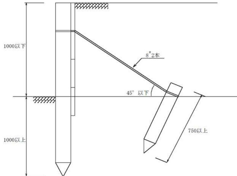
(2) 擁壁の高さ 1 m 超 2 m 以下の場合
