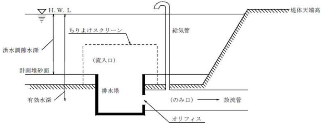
イ 放流管は、鉄筋コンクリート造とし、プレキャスト管を用いる場合も、全管長に渡って鉄筋コンクリートで巻くものとする。また、放流管は不等沈下による破損を防ぐために、10m間隔程度毎に継手を設けなければならない。継手構造は可撓性の止水板を用いて水密性を保つものとするほか、下図を標準とする。
