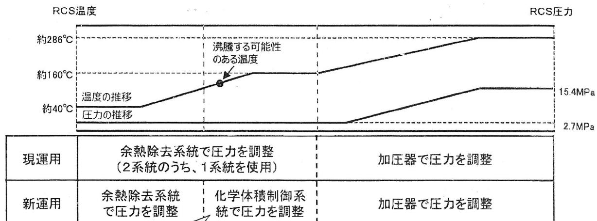
圧力低下により沸騰する可能性のある温度に達する前に、化学体積制御系統を用いた調整に切り替え、余熱除去系統を早期に隔離。
