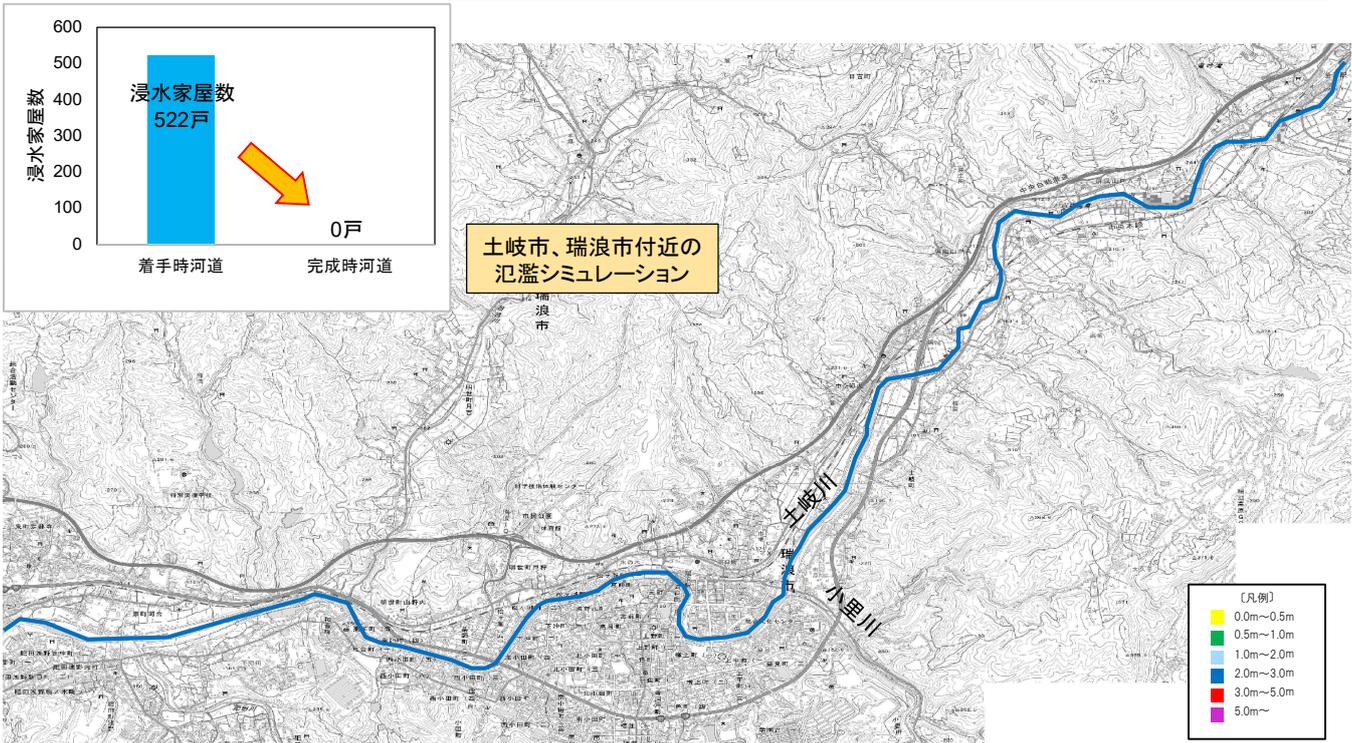
1/30(小里川下流)、1/10(小里川上流)規模の出水による氾濫想定図(完成時河道)(R20未)
