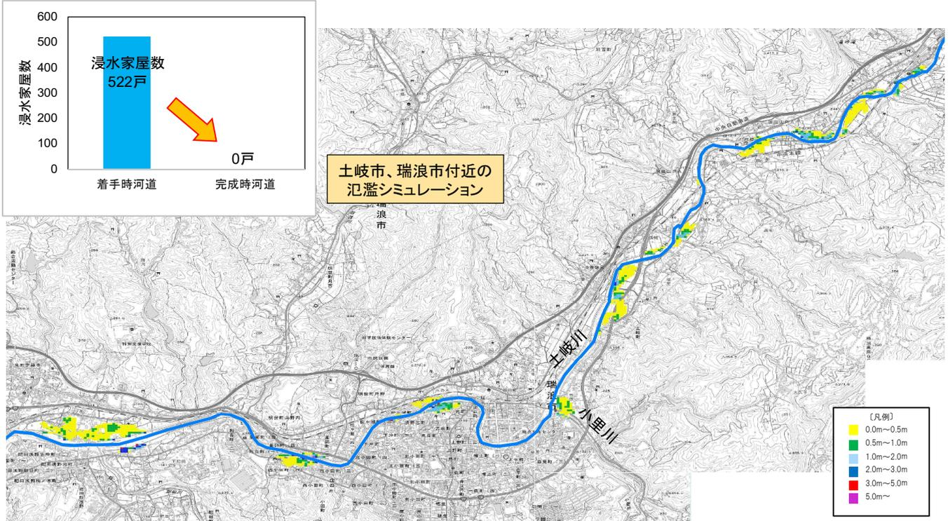
1/30(小里川下流)、1/10(小里川上流)規模の出水による氾濫想定図(着手時河道)(S49未)
