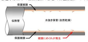
③めくれた箇所が再通水時に剥離することで、流れの乱れが 発生し、注入量を減らしていたことから、保護被膜の形成 が間に合わず、エロージョン・コロージョンにより減肉
