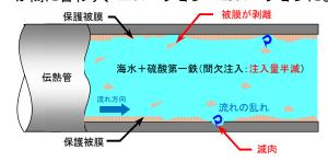
④注入量を戻したが、減肉部の流れの乱れにより、保護被膜の 形成が間に合わない状態が継続し、減肉・貫通に至った
