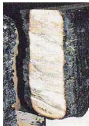
30分間燃焼させた場合の梁の断面。表面に炭化層ができている。
