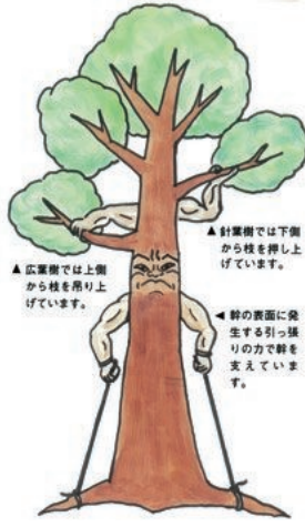
出典:すばらしい木の世界、日本木材学会 図-1 立木にかかる力の模式図
