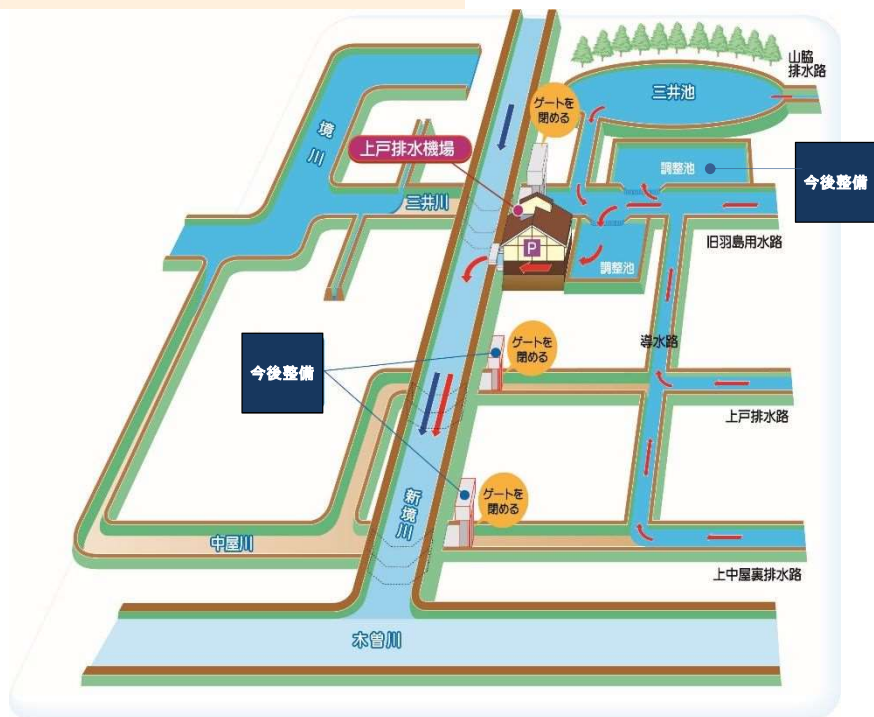
図 2.3 上戸排水機場による排水イメージ
