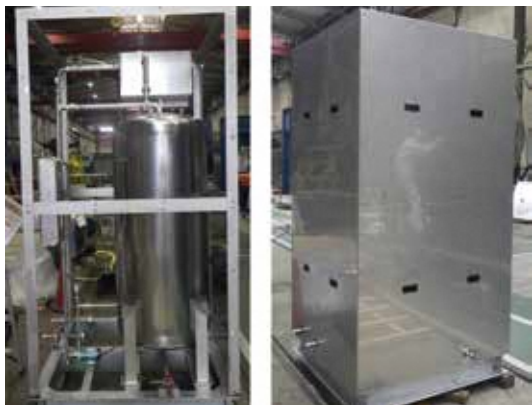
ブラザー工業製燃料電池システム BFCF-5000-DC380V からの熱を回収する「給湯ユニット」試作機の写真
