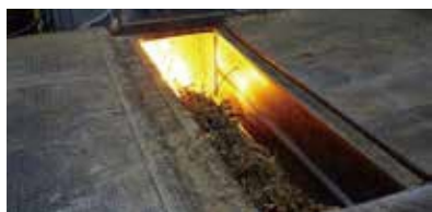
丸太ボイラーにて枝葉の燃焼状況を検証している様子
