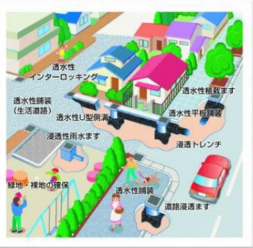
地下水涵養や流域治水のため、雨水の浸透・一時貯留施設等を整備する
