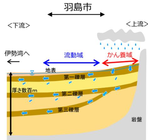
図1 地域の地下水の流れ(断面)
