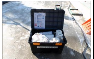
現場常備された油流出事故対策コンテナ
