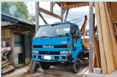
▲【写真4】今須独特の搬出車両(ウインチ併用改造レッカー車)
