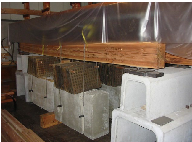
クリープ試験風景 梁に重りを載せた状態で長期間置き、経年による梁のたわみの増加を調べる
