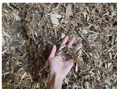
バイオマスボイラーチップ
