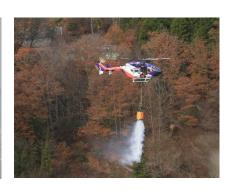
消火訓練:バケツを装着し、水源に浸して給水、放水スイッチを操作して放水
