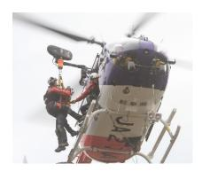
サバイバースリング:要救助者 に装着して垂直状態で吊り上げ 装着して水平状態で吊り上げ
