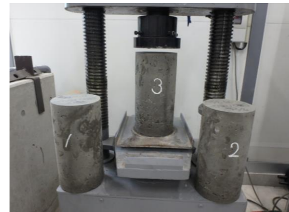
⑦ ダム本体コンクリートの試験状況
