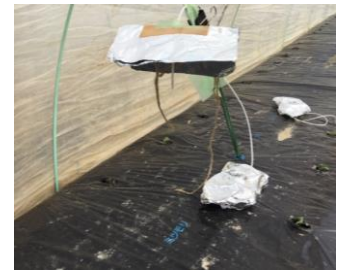
【トンネル内の地温・気温測定】
